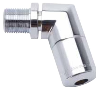
R 799/5 Soffione doccia in ottone fuso per impianti esterni – anticalcare e antivandalo con snodo – economizzatore 9 litri/minuto – brevettato. Vandal-proof shower head for external system with ball joint made in fused brass – flow reducer 9 l/min – patented.
