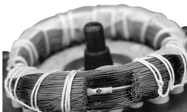
Fig. 45 Sensore PTC incorporato negli avvolgimenti
