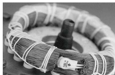
Fig. 47 Interruttori termici incorporati negli avvolgimenti
