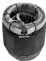
Fig. 43 Motore elettrico a velocità fissa con riscaldatore anticondensa
