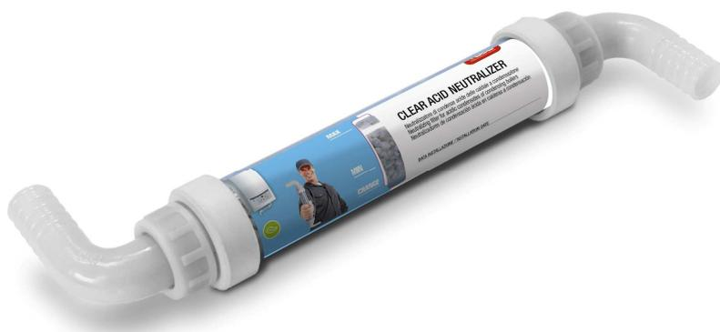
Le caldaie a condensazione producono condense acide (pH compreso tra 3,8 e 5,2) che devono essere neutralizzate prima di essere convogliate allo scarico. La GEL dispone di filtri neutralizzatori che neutralizzano l'acidità dell'acqua di condensa, mantenendo il pH sempre entro i limiti consentiti. Sono disponibili diversi modelli in funzione della potenzialità della caldaia.
