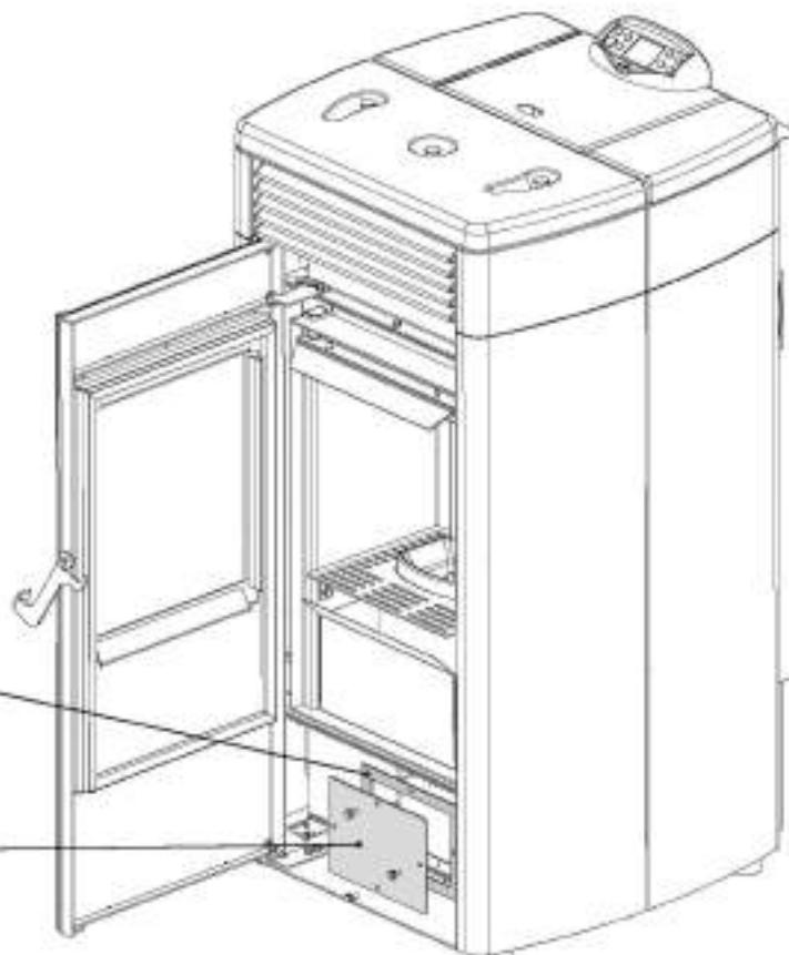
**Accesso alla ventola tangenziale nel modello HRV120 / Access the crossflow fan in model HRV120 /
