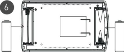
Inserire 2 batterie da 1,5 Vdc LR6 AA rispettando la polarità indicata
