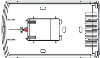
Chiudere l'involucro del relè con l'uso di un cacciavite
